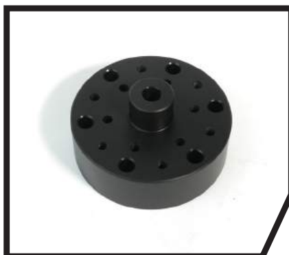
Cod. N025.96 Distanziali elica 30 mm con 3 forature: interasse 50 mm - viti M6 interasse 70 mm - viti M6 interasse 75 mm - viti M8 Prop spacer - different holes
